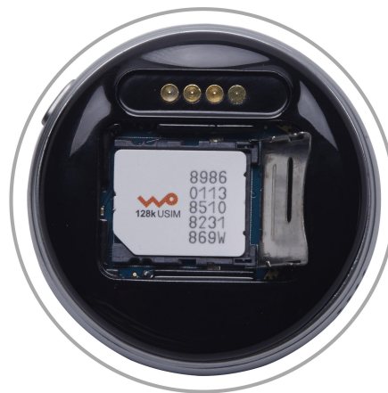
2. Introduceți SIM-ul exact ca în poza de deasupra (atenție la capacul metalic, acesta culisează înspre dreapta, după care se ridică în sus)
