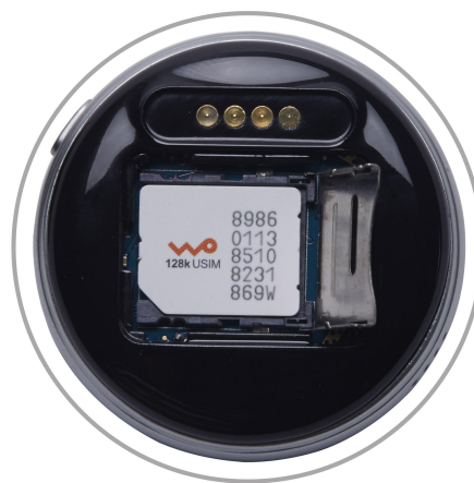
2. Introduceți SIM-ul exact ca în poza de deasupra (atenție la capacul metalic, acesta culisează în dreapta, după care se ridică în sus)
